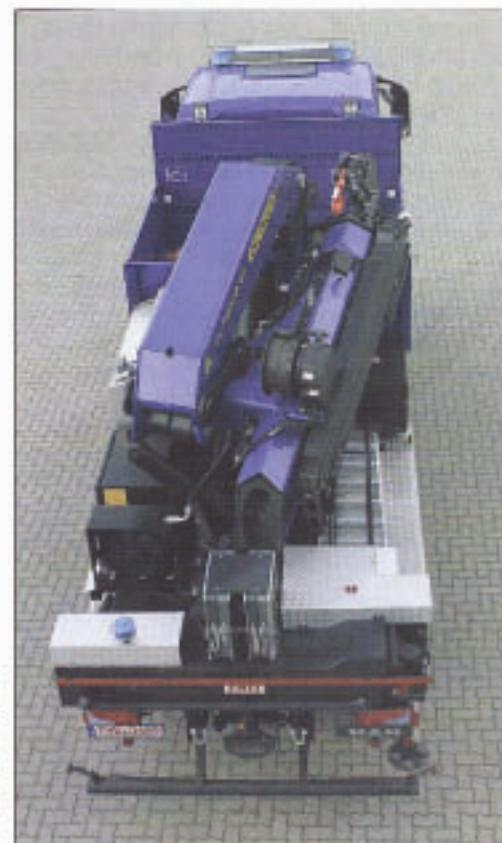
Aufgrund der hohen Bauweise des MAN TGS 28.400 wird in Augenhöhe kaum deutlich, dass der Ladekran in Ruhestellung nicht rechtwinklig auf dem Fahrgestell fixiert ist.
