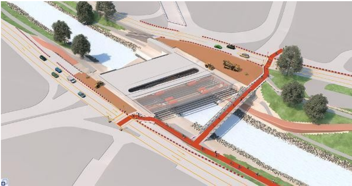
Bauphase 8 – Mai bis Juni 2016: Die Stahlunterspannung wird montiert, das Traggerüst ergänzt und mit dem Überbau begonnen.
