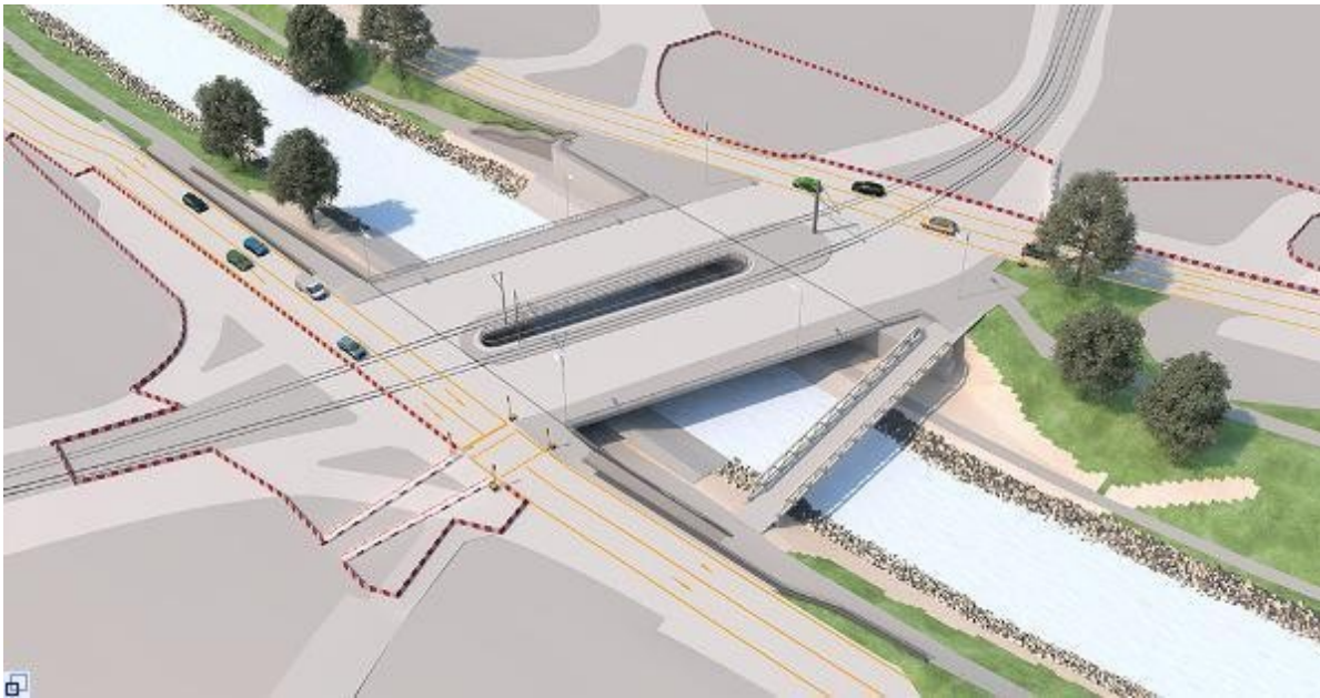
Bauphase 12 – April bis Sommer 2017: Das Baufeld an der Kronenbrücke wird verkleinert, die Baufelder südlich und nördlich der B31 eingerichtet, Straßen- und Gleisbau südlich und nördlich der B31, die Behelfsbrücke wird rückgebaut.
