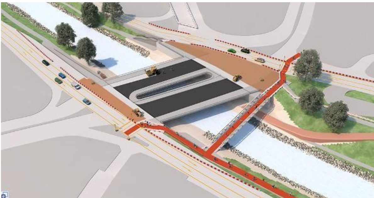
Bauphase 9 – Juni bis Oktober 2016: Das Traggerüst wird abgebaut, die Brücke abgedichtet und der Asphalt aufgetragen.
