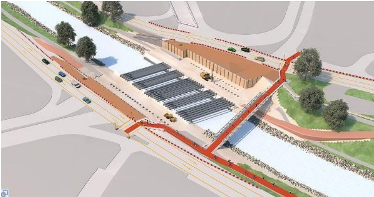
Bauphase 6 – September bis November 2015: Die Tiefgründungen für die Brücke werden hergestellt.
