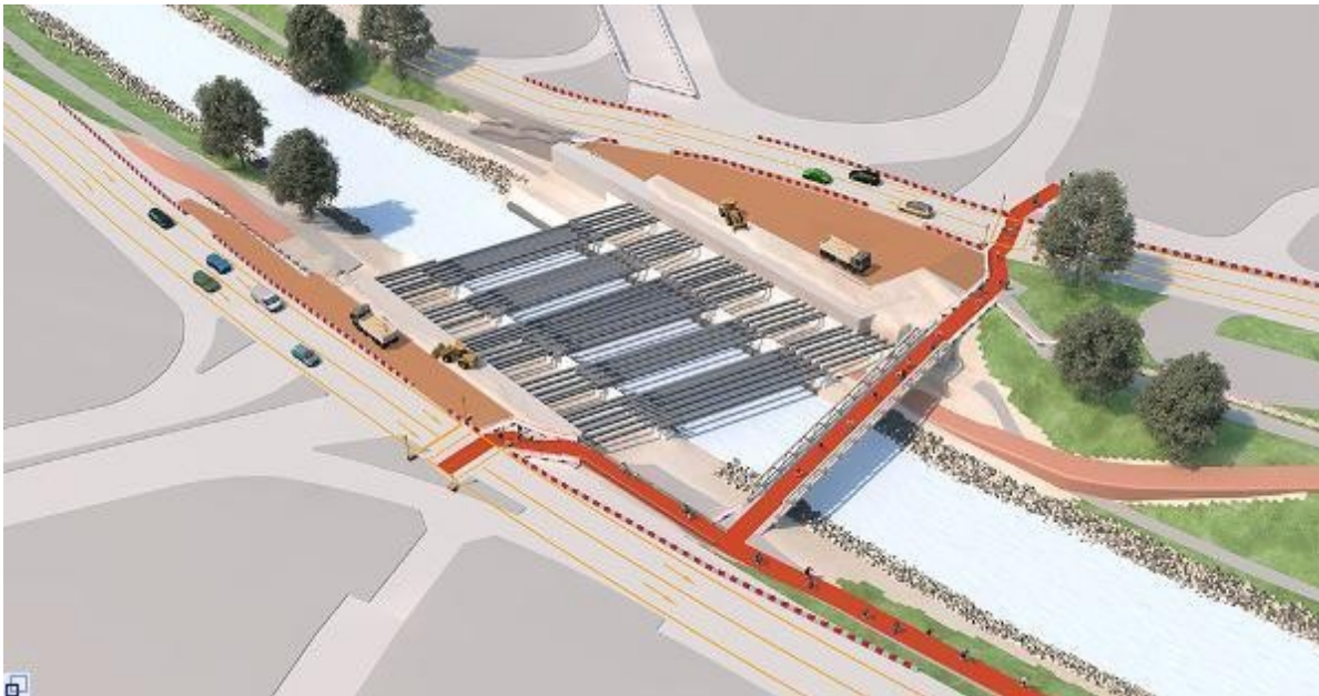
Bauphase 7 – November bis April 2016: Die Widerlager werden gebaut, die Baugrubensicherung zurückgebaut und das Traggerüst für den Bau der Brückenplatten vorbereitet.
