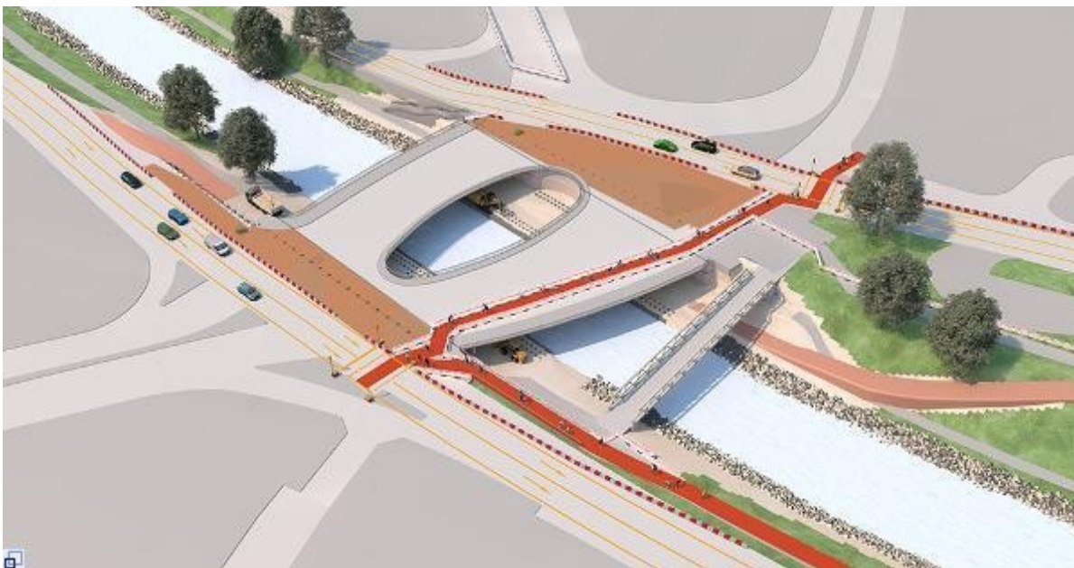
Bauphase 3 – April bis Juni 2015: Die Hilfsgründung für das Abbruch- und Traggerüst unter der Brücke und die Träger für die Baugrubensicherungen werden hergestellt, die Behelfsbrücke wird montiert.
