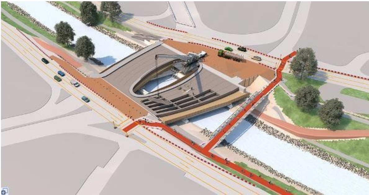
Bauphase 4 – Mai bis September 2015: Bau des Abbruch- und Traggerüsts, Abbruch der Kronenbrücke.
