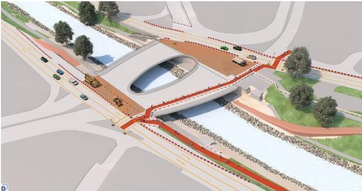
Bauphase 2 – Mai bis Juni 2015: Die Baustraße wird hergestellt, die Baugrube ausgeschachtet und der Bau der Behelfsbrücke vorbereitet.
